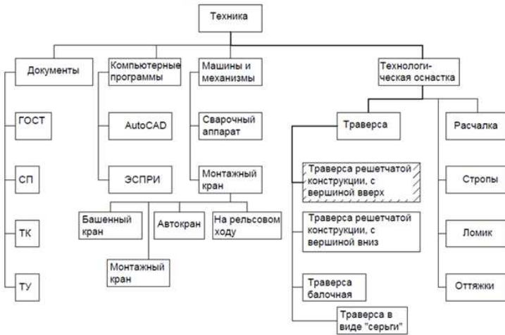
Рисунок 10. Структура выбора компонента «Техника» в исследуемой системе ЧТС
